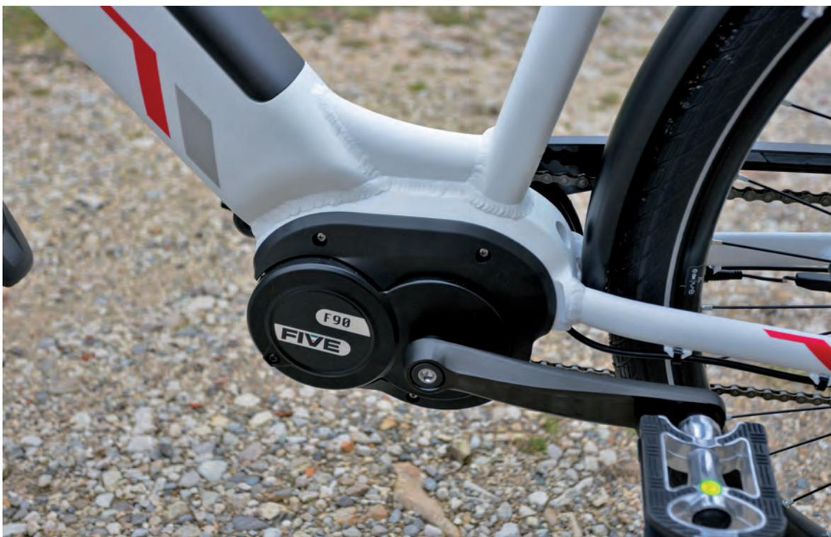
vertici del suo segmento, e da un rumore di fondo molto basso durante il funzionamento. Dispone di un sensore di coppia e centralina integrati che misurano lo sforzo del ciclista sui pedali modulando opportunamente la quantità di energia erogata dal motore. La presenza del sensore di coppia, e non del solo sensore di pedalata come in uso nei sistemi più semplici, consente di gestire la potenza del motore e dell'assistenza richiesta
