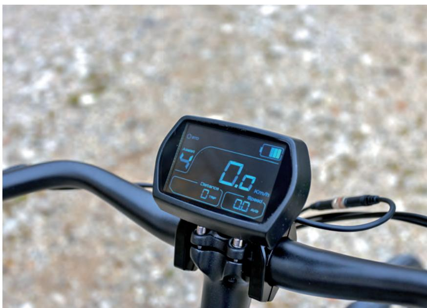
dati necessari durante la corsa, con maggior rilievo per la velocità, il livello di carica della batteria e il livello di potenza selezionato. La pulsantiera posta a sinistra, vicino al campanello, permette di accendere e spegnere il sistema, oltre a spostarsi nei vari menu e di variare il livello di aiuto. È presente anche una porta USB idonea per la ricarica dello smartphone.
