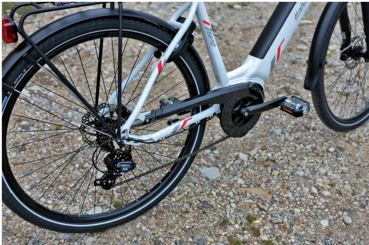
7 rapporti della cassetta posteriore tramite un comando rotativo. I sistemi Shimano si rivelano ancora una volta molto efficienti e affidabili anche dopo molti chilometri.
