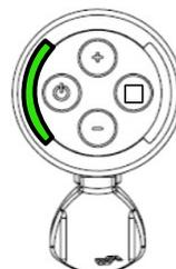
**g.** Se con display acceso appaiono due led rossi lampeggianti sono presenti malfunzionamenti, si prega di contattare l'assistenza.
